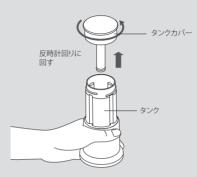
2 タンクを外します。 コンテナカバーを支え、タンクを反時計周りに 回すと、タンクが外れます。
