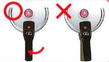
きちんとフタが閉まっていない状態で加熱をすると、安全装置が正常に働かず、鍋が爆発し怪我をする恐れがあります。また、スライドが熱で変形し、故障の原因となります。
