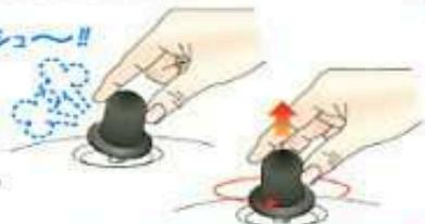
3 ブッシュボタンを押しながら、フタを少し反時計回りに回転させて一度止めた時、フタの隙間から蒸気が出でていないことを確認してから、フタのマ印が本体取っ手の△印にくるまでフタを回転させて下さい。この時、取っ手の動きが重く感じられる時は、鍋の内側にはまだ圧力がかかっている可能性があるので、無理に開けると危険です。1・2の確認をし、まだ取っ手の動きが重いようでしたら、P8の急冷にそって水をかけ冷やしてから、再度上記1からの手順で開けて下さい。
