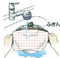
開閉スイッチや調圧スイッチに水がかからないように!
