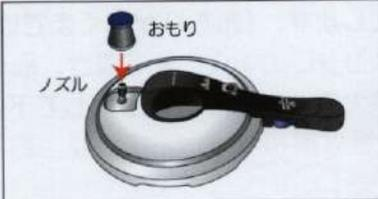
圧力調整装置(ノズル)の上におもりをカチッと差し込んで下さい。おもりの中心が、ノズルの真ん中になるように真上から差し込んで下さい。
