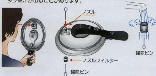
**MAXUSの2way圧力調整装置(ノズル)は普通圧調理(80kpa)と高圧調理(144kpa)の切り替えが出来ます。**
