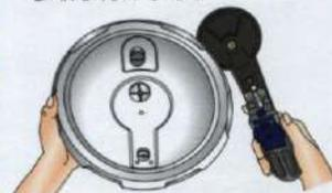
③コインなどを使用して、フタの裏側3ヶ所にMS-15フタ取っ手締め付けボルトを止まるまできつく締めます。
