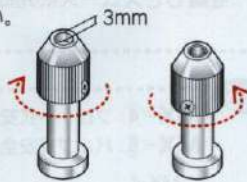
低圧調理 高圧調理 ふたに表示してあるHIGHは高圧、LOWは低圧の意味です。
