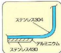
板厚1mmの本体ステンレスの外に、厚いアルミニウムと薄いステンレスを貼り合わせ(底圧合計5.5mm)下からの熱を分散させ、内部全体に熱が均等に伝わり調理がうまくできます。
