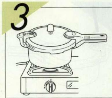
所定の加熱時間が終わったら火を消してください。**蒸らし時間**のあるものは所定の時間そのまま放置いたします。火を消してもしばらくは100度以上を保ちます。この間表示ピンが下っても高温を保ちます。(急冷の場合は蒸らし時間はありません。(7ページ参照))
