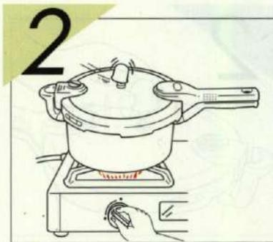
圧力表示ピンが上がり、しばらくしてシュッシュッと音をたておもりがゆれ始めます。これが**加熱時間**開始の合図です。次に火を弱めます。火加減は、ゆっくり左右にゆれる程度に調整します。このまま加熱時間終了まで続けます。
