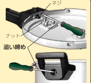
またノズル・バルブ式安全装置・フロートの緩みは、部品が加圧中に外れて飛び出し、けがをする恐れがあります。
