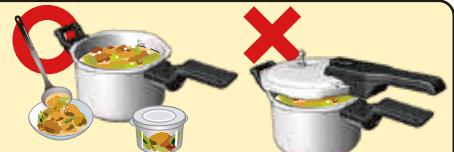
**強制** 油脂分の多い食材(すじ肉・スペアリブなど)を一度に大量に調理すると、油脂分が固着して安全装置が正常に作動しなくなることがあります。
