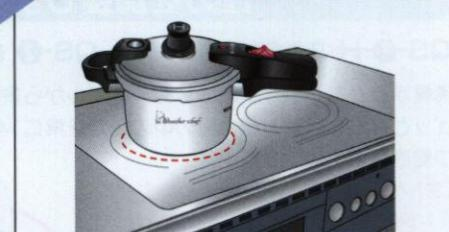
IHクッキングヒーターは他の熱源と違い、鍋自体を発熱させる装置です。それもドーナツ状の部分だけ発熱します。従って「強」で使えば急速に熱くなるので、金属でも必ず膨張し、使っているうちにゆっくりと変形していきます。
