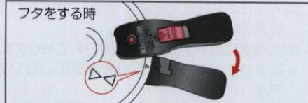
本体取っ手の△マークと、フタのママークを合わせ、フタを時計の針と同じ方向に回し、本体とフタの取っ手が一直線に重なるようにセットして下さい。
