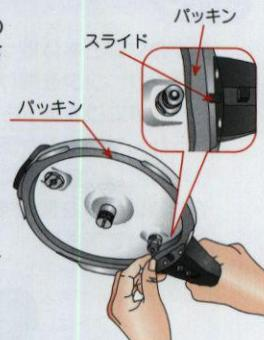
※フタの内側の外枠に取り付けておりますパッキンは、ご使用により劣化します。また、使用期間が短くても、洗浄中などに傷が付き、劣化することがあります。劣化した場合、調理中にフタと鍋本体の間から蒸気が漏れたり、水滴が落ちたりします。そのような状況が起きましたら、そのパッキンを継続使用せず、新しい物に交換して下さい。
