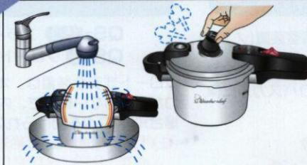
調理後、火を止めても圧力鍋の内部には、まだ圧力が残っています。フタを開ける時、鍋の中に少しでも圧力が残っていると、フタが飛んだり、内容物が噴き出したりして非常に危険です。必ず圧力が下ったことを確認の上、おもりをはずしてから、P12の手順にそってフタを開けましょう。(※急冷の方法はP13を参照して下さい。)
