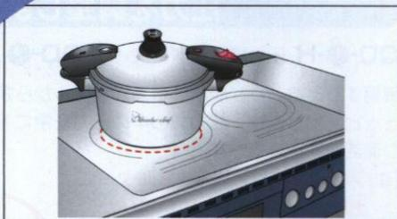
IHクッキングヒーターは他の熱源と違い、鍋自体を発熱させる装置です。それもドーナツ状の部分だけ発熱します。従って「強」で使えば急速に熱くなるので、金属でも必ず膨張し、使っているうちにゆっくりと変形していきます。
