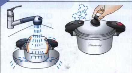
調理後、火を止めても圧力鍋の内部には、まだ圧力が残っています。フタを開ける時、鍋の中に少しでも圧力が残っていると、フタが飛んだり、内容物が噴き出したりして非常に危険です。必ず圧力が下がったことを確認の上、おもりをはずしてから、P12の手順にそってフタを開けましょう。(※急冷の方法はP13を参照して下さい。)
