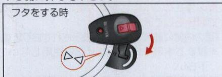
本体取っ手の△マークと、フタの▽マークを合わせ、フタを時計の針と同じ方向に回し、本体とフタの取っ手が一直線に重なるようにセットして下さい。
