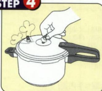
おもりを持って静かに手前へ傾けて下さい。(鍋の中に圧力が残っていれば、シャットと抜けます)
