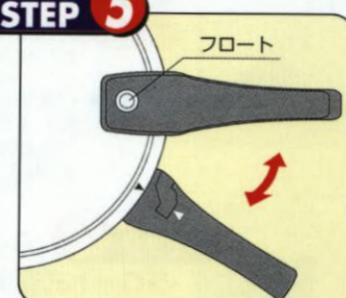
フロートが沈んでいるのを確認してふたを廻して(時計の針と反対方向に最初の▲マークの位置まで)、真上に持ち上げて外す。
